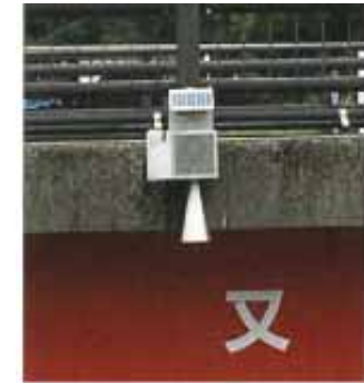
橋梁に設置するタイプ （電波や超音波で河川に触れずに計測）
