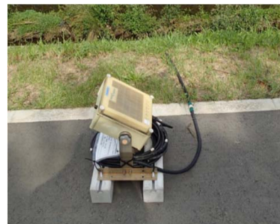
堤防に設置するタイプ （ケーブル（計測器）を河川に入れて計測）
