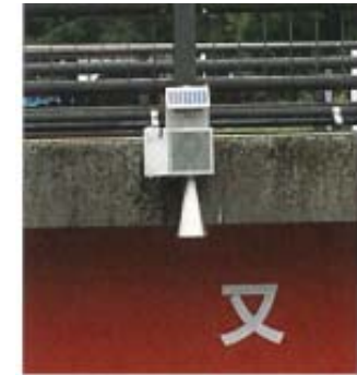
橋梁に設置するタイプ （電波や超音波で河川に触れずに計測）
