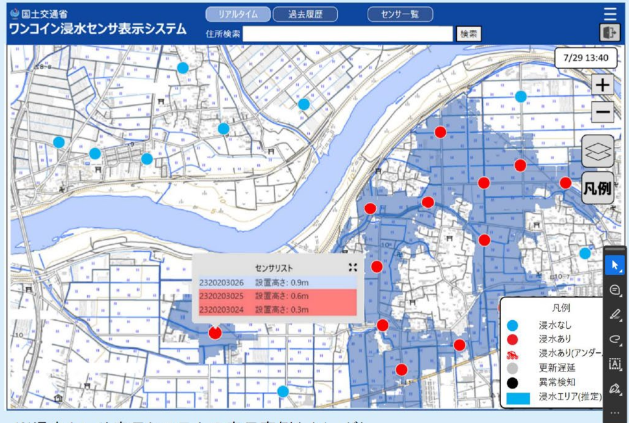
※浸水センサー表示システムの表示事例(イメージ)
