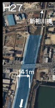
河口部から約900mの引堤完了 次のネック点は、新相川橋
