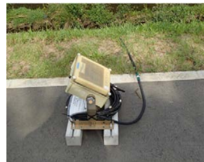
堤防に設置するタイプ （ケーブル（計測器）を河川に入れて計測）
