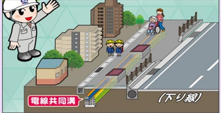
本工事は、鈴鹿市の国道23号線における電線共同溝工事です。施工場所は、白子町の下り線にて電線共同溝を作ります。電線共同溝工事の施工は、歩道内での作業が主ですがプレキャストボックス等重量物施工・路肩排水路等作業により歩道規制及び1/2車線通行規制での施工を行い、作業時間は夜間施工(21時～6時)にて現場施工を行います。作業に際しましては、一般車両や歩行者の安全確保をはかり、事故防止に万全を期し、安全作業に努め作業を完了させますので御協力と御理解のほど、よろしく御願い申し上げます。
