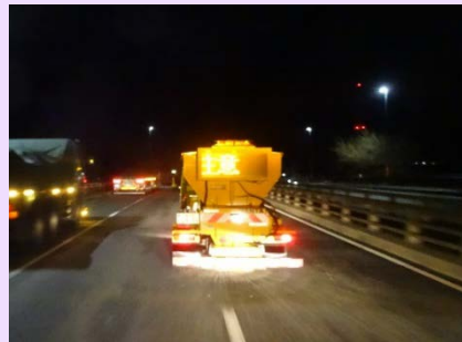
凍結防止剤散布作業
