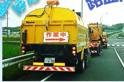
路面清掃車は、文字通り、路面を清掃するための車両です。路面清掃をする際は、散水車と一緒に動きます。散水車が水をまき、路面清掃車が、汚れ（土砂等）を吸い取ります。三重河川国道事務所が保有する路面清掃車は、真空環流式と呼ばれる方式で、圧縮した空気を路面に叩きつけ、舞い上がらせてから吸い込みます。津国道維持出張所では、春と秋の年2回、路面清掃を行っています。
