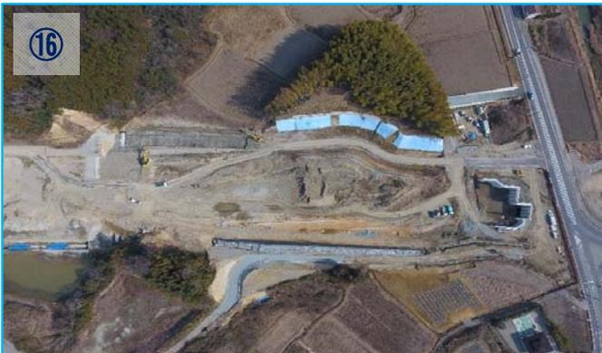
付替道路の排水構造物工と市道舗装工を3月末工事完了に向けて施工を行っています。
