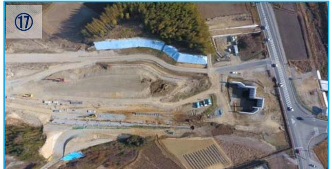
⑰ 付替道路となる箇所、掘削工事を行い、擁壁と排水構造物を施工しています。
