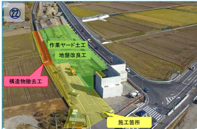
構造物撤去工・作業ヤードの整備を行い、12月下旬より地盤改良工を行っていきます。
