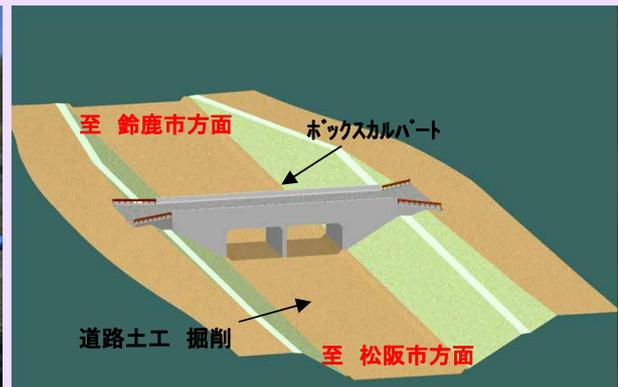
中勢バイパスのボックスカルバードの施工を行う㈱松本組です。11月で掘削工事も完了しました。12月からボックスカルバードの施工を行っております。工事は安全第一で進めていきますので、宜しくお願いします。
