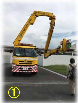
今月は珍しい建設機械の紹介をします。写真①の車輛は「橋梁点検車」といいます。クレーンの先についているバケットに人が乗って橋の裏側の点検をします。今の時期にはアチラコチラの事務所から貸して欲しいという希望が殺到して引っ張りだこの人気者です。写真②の車輛は舗装が傷んで凸凹になった時に舗装を5cm~10cm削って、新しいアスファルトを敷設するという工事をするのですが、その時に舗装を削る機械で「路面切削機」といいます。
