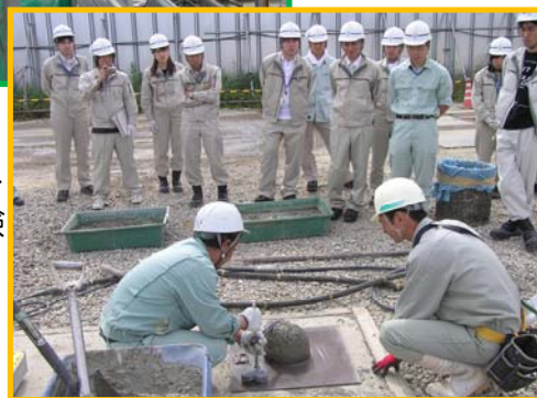
コンクリート スランプ試験 の様子
