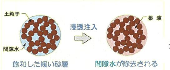
原理：浸透注入により、土粒子の骨格を壊さずに
