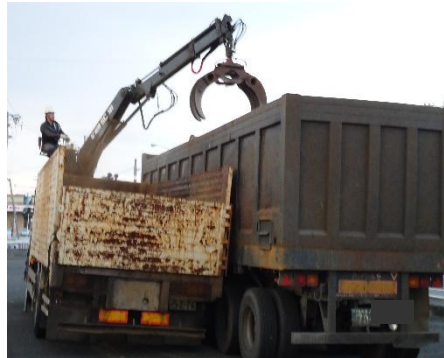
重量超過車両の減載措置状況
