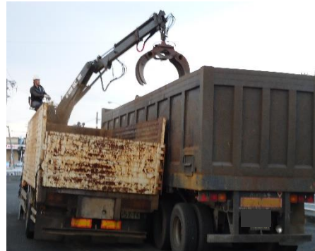
重量超過車両の減載措置状況
