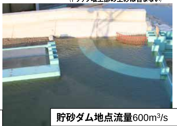
図 流量ごとのトラップ堰による砂礫捕捉率 ※砂礫捕捉率=トラップ堰前面に堆積土砂量/投入土砂量 (トラップ堰上部の土砂は含まない)
