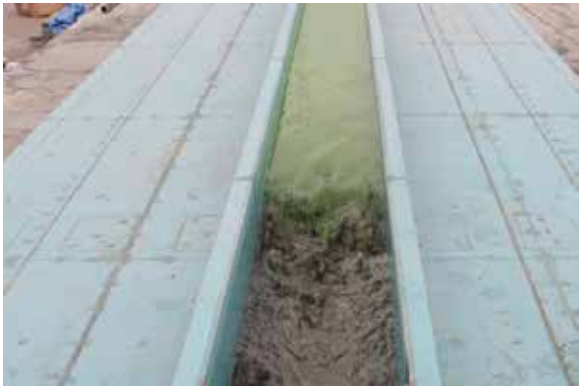
縮尺1/15実験での段落ち状況
