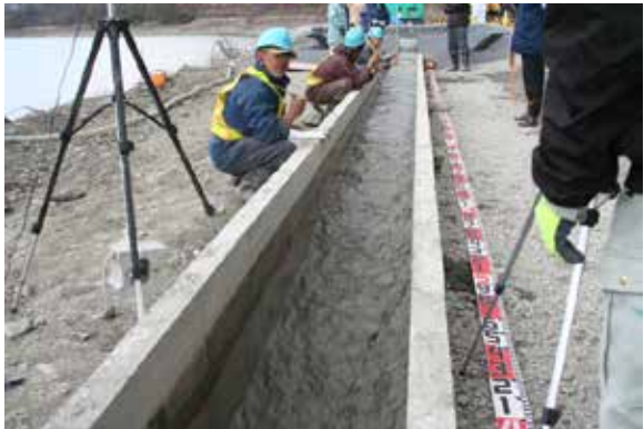
縮尺1/5実験での段落ち状況
