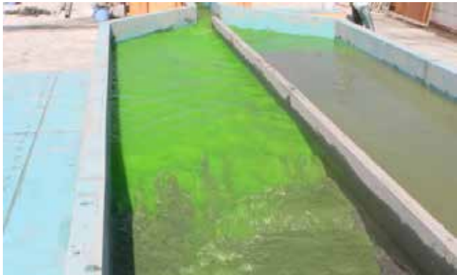
縮尺1/25実験での段落ち状況
