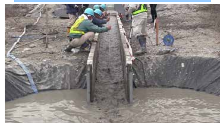
1/5縮尺模型 (設計条件: q=2.00\text{m}^3/\text{s}/\text{m} )
