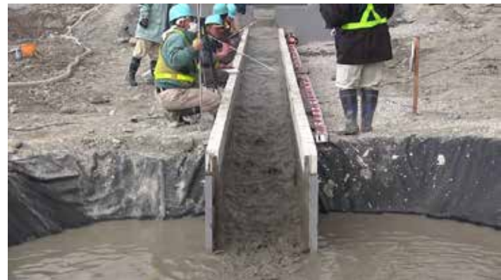
1/5縮尺模型 (縮尺効果の検討 q=1.25\text{m}^3/\text{s}/\text{m} )
