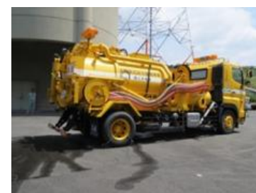
排水管清掃車(1台)
