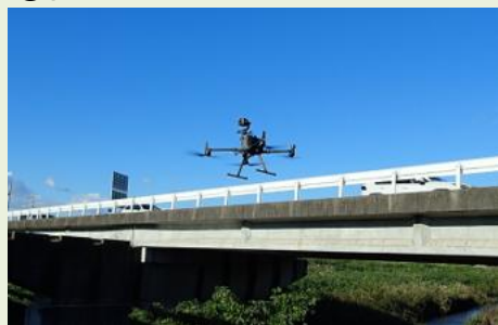
川の上など、近づいて見ることができない橋の点検
