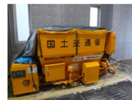
凍結防止剤散布機(9台)
