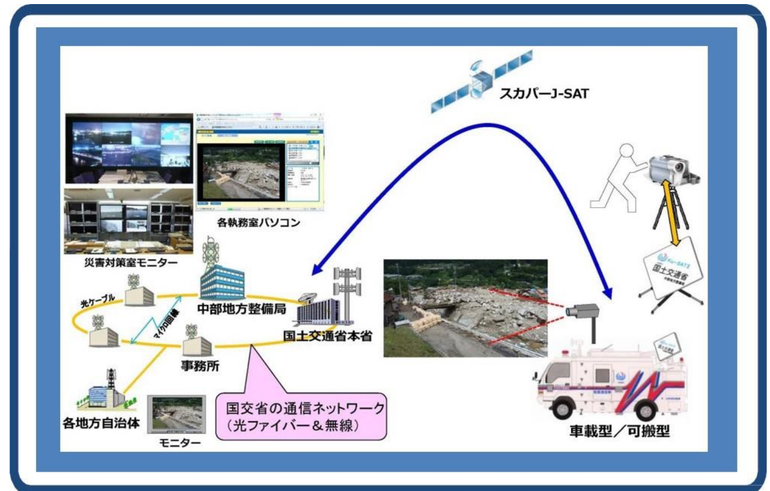
衛星通信車を活用した映像配信システム（イメージ）
