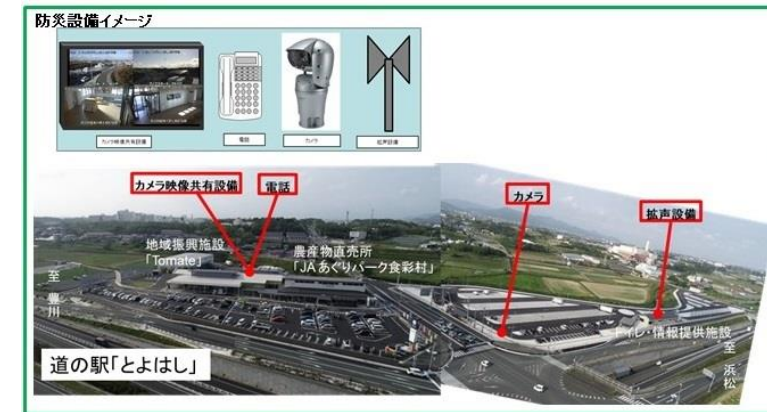
【ハード面の事例：「道の駅『とよはし』防災機能強化方策検討会」で議論し、設置された防災設備】
