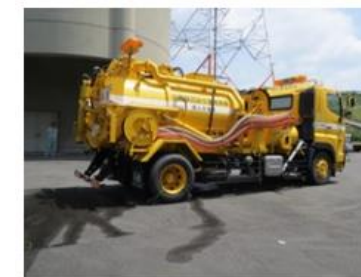
排水管清掃車(1台)
