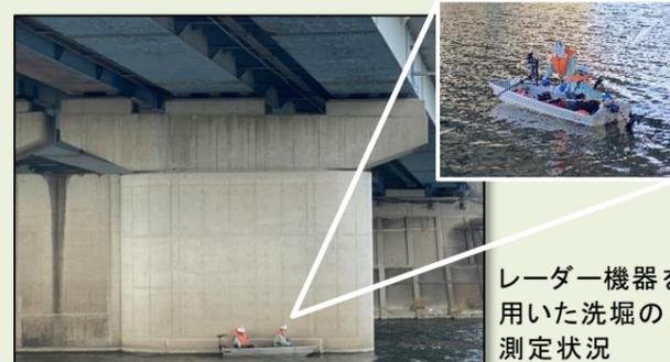
レーザー機器を用いた洗堀の測定状況
