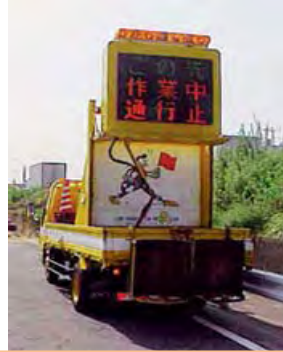
(1994年 発行ダイオード表示板搭載車両)
