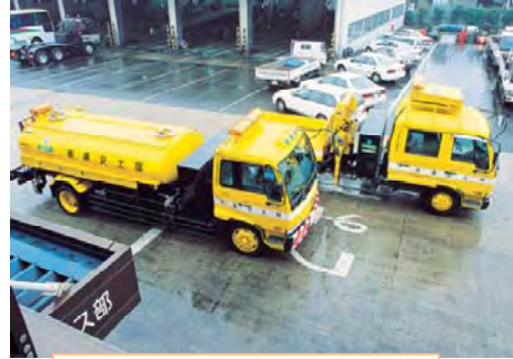
(2000年 CNG燃料の維持作業車)
