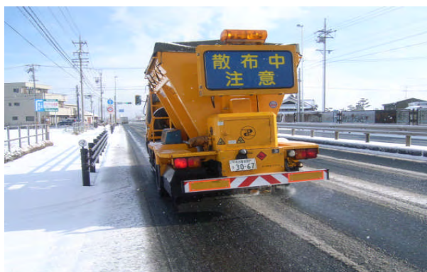
自走式散布車による薬剤散布作業（昭和60年代～現代）
