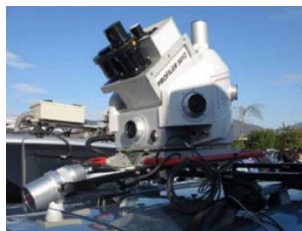
車載装置による路面性状測定
