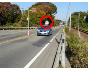
車載装置による路面性状測定
