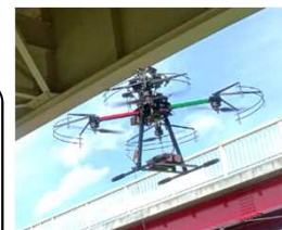
ドローンによる損傷把握
