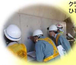
クラックスケールでひび割れ幅を測定
