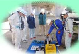
鉄筋かぶりの非破壊試験
