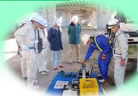
鉄筋かぶりの非破壊試験
