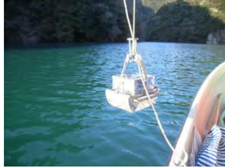
調査実施状況（エクマンバ－グ型採泥器）
