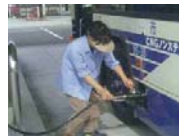
圧縮天然ガス充電の様子
