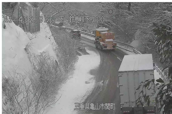
三重県亀山市関町 2/8(土)10時頃 ※通行止め解除後の凍結防止剤散布状況
