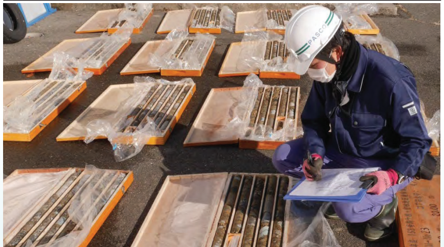
ボーリングコア試料観察の作業状況
