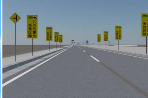
図 国道1号における事故対策案を3次元化した事例
