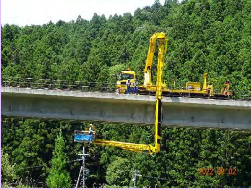
8月2日(火) 橋梁点検車の機能確認を実施
