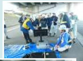
赤外線によるコンクリートの浮き・剥離検出技術
