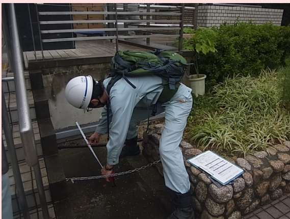
9月6日 南海トラフ地震を想定した合同防災訓練② 名古屋地方合同庁舎第2号館 緊急Ⅱ次点検(左:免震装置水平変形の計測、右:庁舎・設備被害の報告) (営繕部・静岡営繕事務所)
