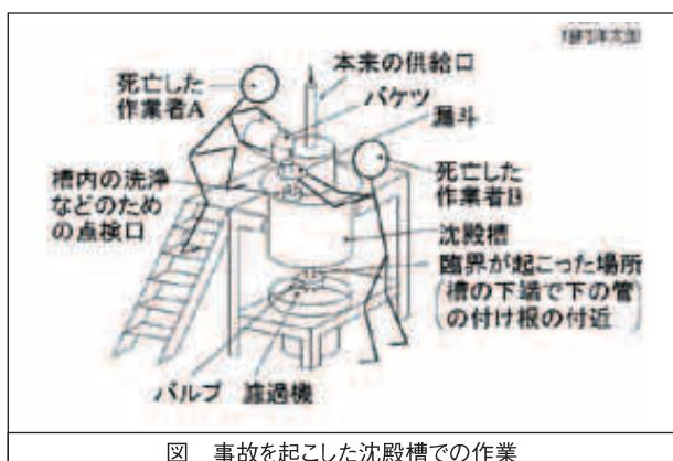
図 事故を起こした沈殿槽での作業
