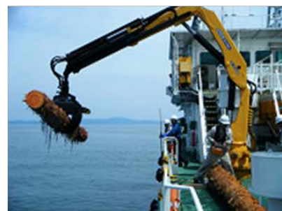
流木回収状況
