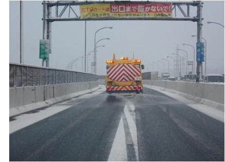
溶液散布の状況（本線部）
