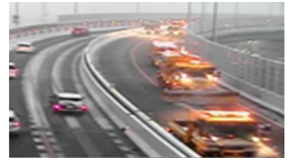
梯団除雪の状況
