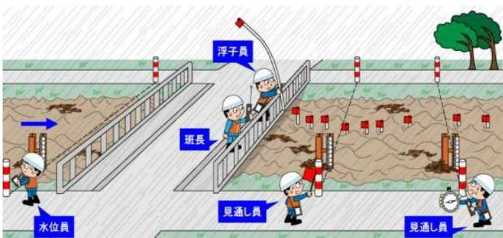
一般的な流量観測の模式図（洪水時）
