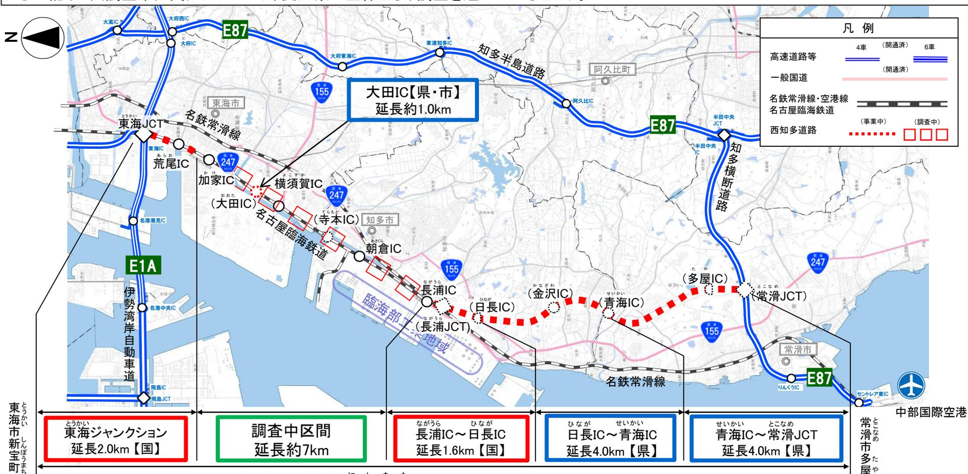
西知多道路 約18.5km ※大田IC及び長浦JCT～常滑JCT間のIC・JCT名は仮称
