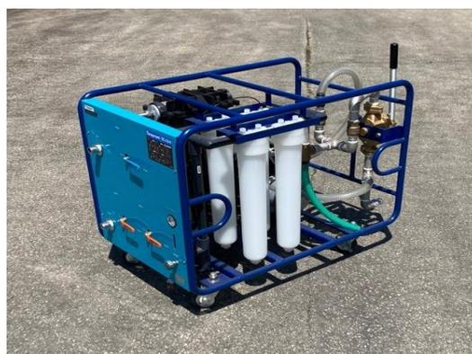
写真-9 緊急用浄水装置（飛騨市）
