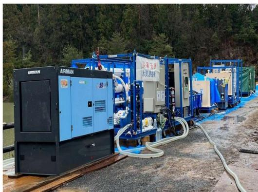
写真-8 大型可搬型浄水装置
