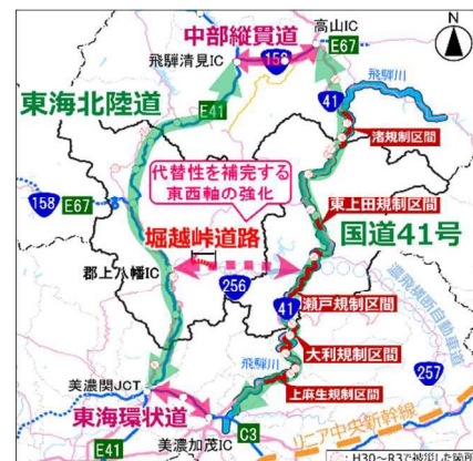
国道256号堀越峠道路 ダブルネットワークの代替性を補完
