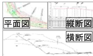
設計図から施工土量を算出
