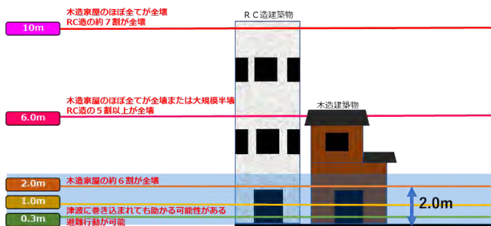
図 東日本大震災時の浸水深と建物被害の状況
