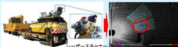
※道路用のデータ計測車両を鉄道台車に搭載し、けん引
