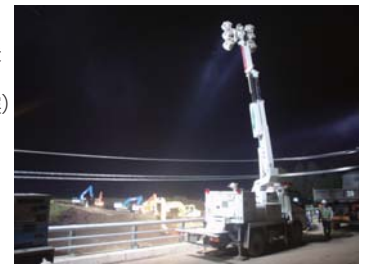
照明車による 夜間作業支援 (平成30年 北海道胆振東部地震)
