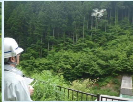
UAVを用いて砂防施設の変状及び堆砂状況を調査し、土砂を捕捉する機能を確認する実習
