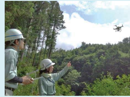
UAVを用いて砂防施設の変状及び堆砂状況を調査し、土砂を捕捉する機能を確認する実習
