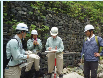
砂防施設の損傷状況及び溪床様子や溪岸浸食の状況を調査・記録する実習
