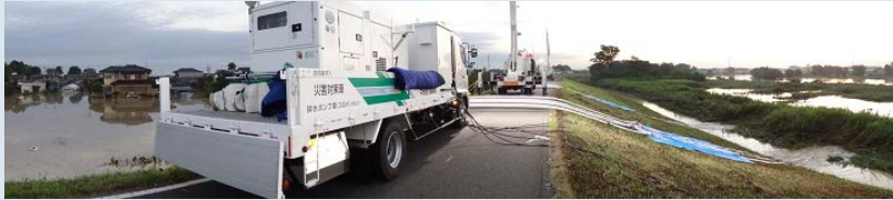
『平成27年9月関東・東北豪雨』鬼怒川決壊に伴う浸水箇所での活動中の排水ポンプ車及び照明車
