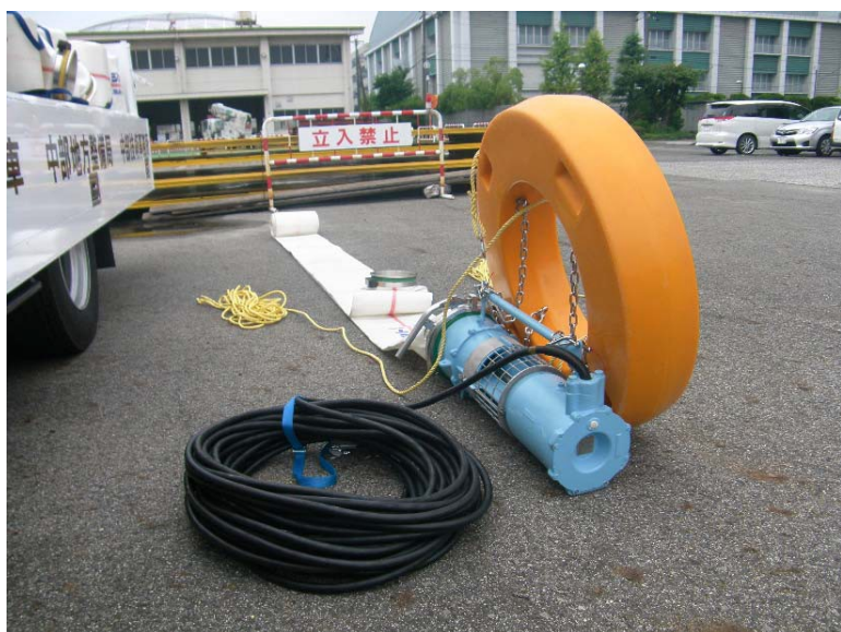
排水ポンプ (Φ200mm 7.5m 3 /min×4台 全揚程10m)
