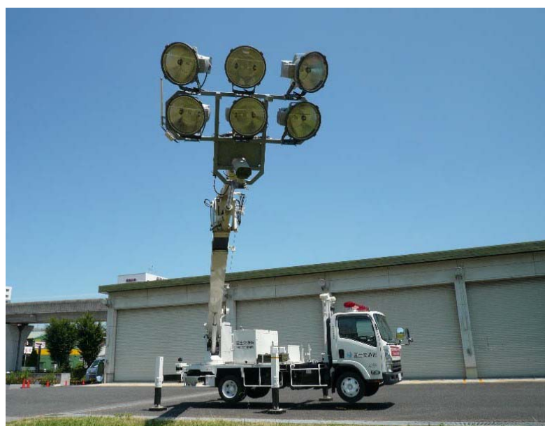
照明装置 (2kW×6灯)
