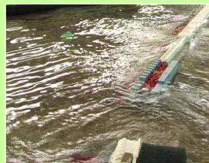
平面水槽 防波堤安定実験
